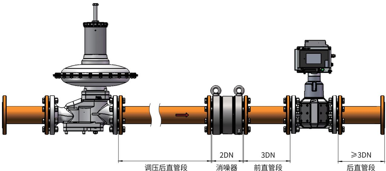
图 5-7 DN80~DN200 安装方式（调压器后 + 消噪器）
