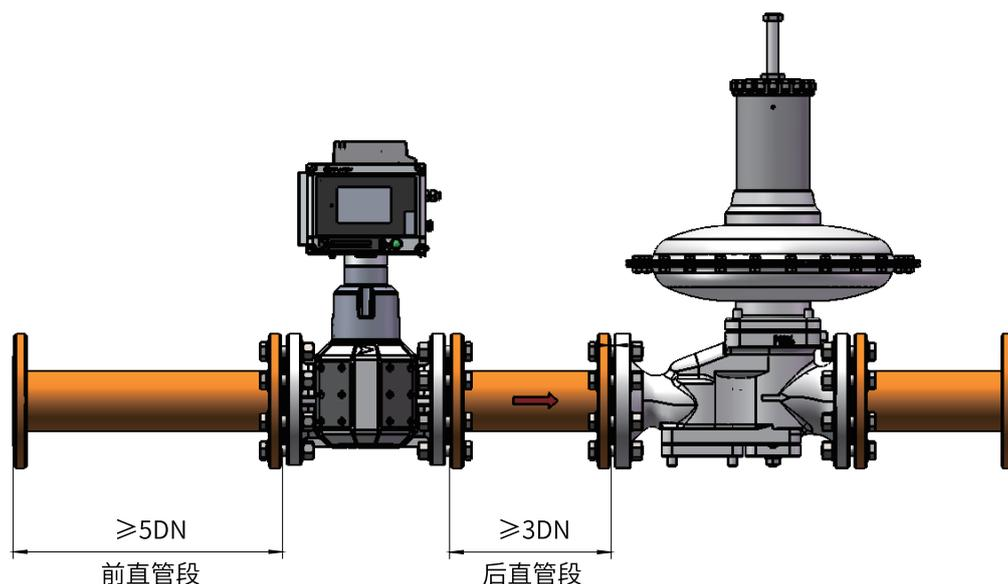
图 5-10 DN25~DN200 安装方式（调压器前）
