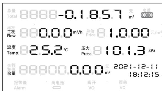
图 6-13 双向计量第四屏显示 - 反向工况体积量和 K 系数
