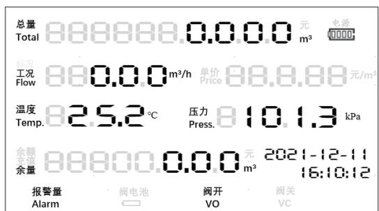
图 6-7 表端气量结算第一屏显示 (已开户)
