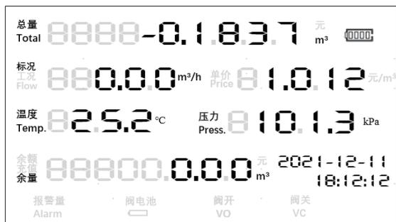
图 6-12 双向计量第三屏 - 反向标况体积量和转换系数 C
