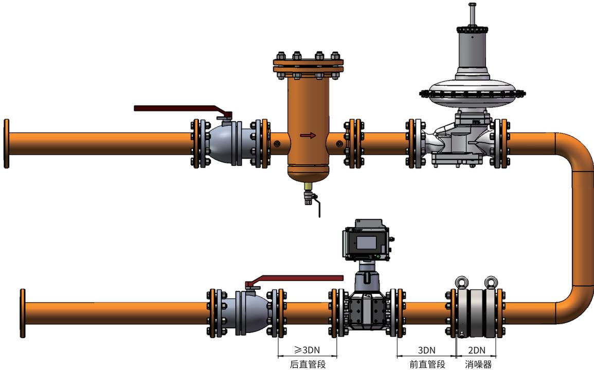
图 5-9 DN150~DN200 安装方式（调压器后 + 消噪器）
