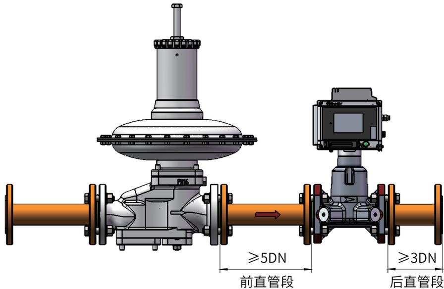
图 5-6 DN25~DN50 安装方式（调压器后）
