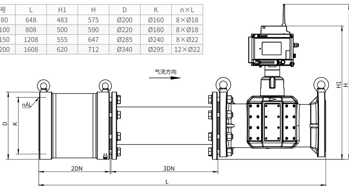
图 5-3 消噪器选型及安装方式
