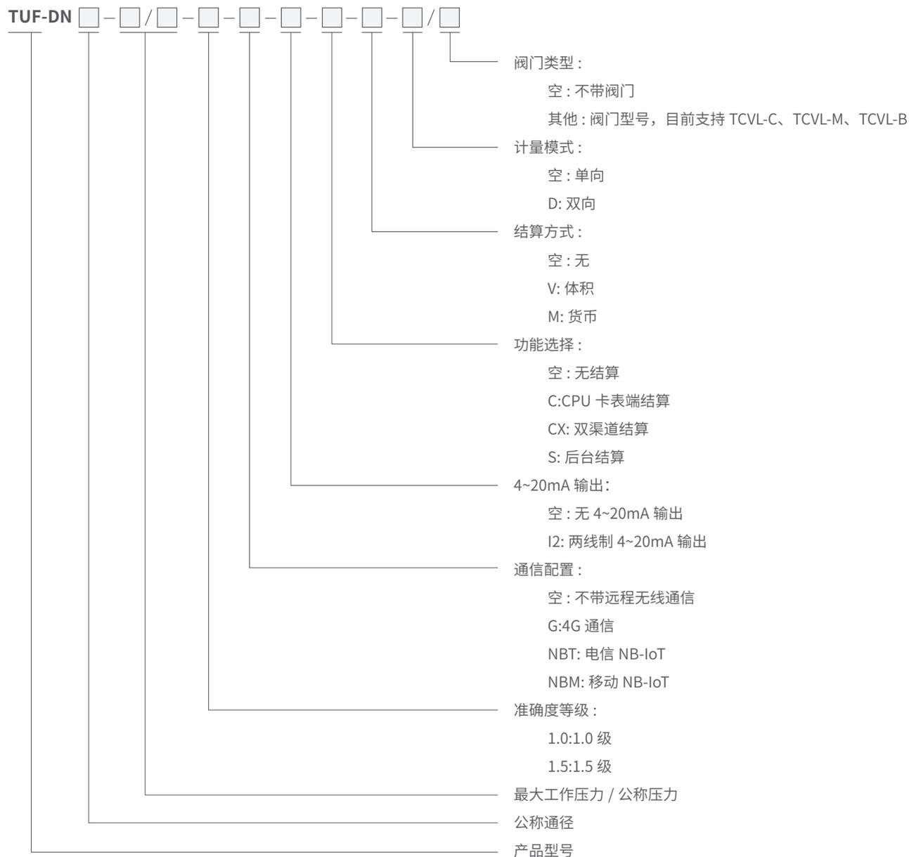
举例：管道公称压力 1.6MPa，介质最大工作压力 0.5MPa，口径 DN100，准确度等级 1.0 级，后台货币结算，电信 NB-IOT 通信，单向计量，则型号为：
