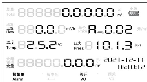
图 6-8 表端气量结算第二屏（显示 Modbus 地址）
