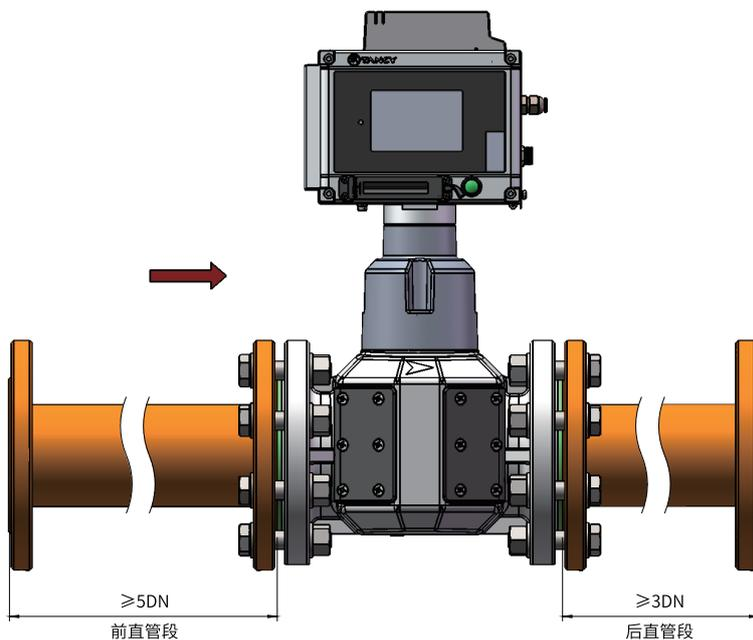
图 5-4 气体超声流量计推荐安装方式
