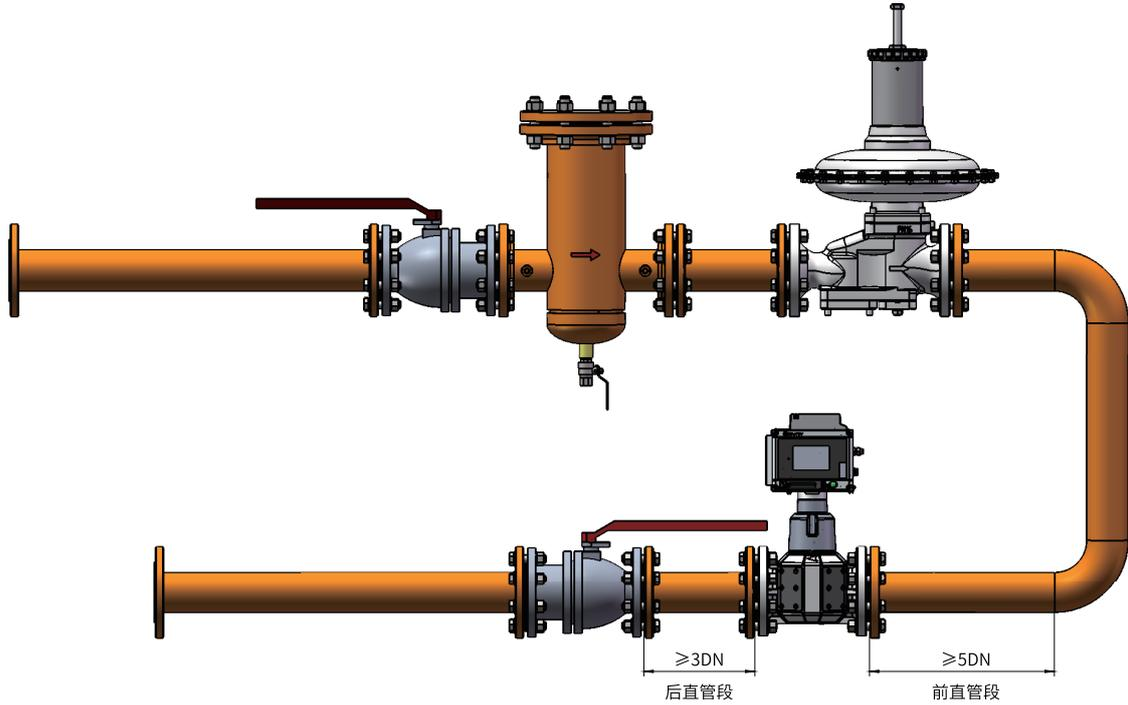
图 5-8 DN25~DN100 安装方式（调压器后）
